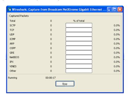
Capturez environ 30 secondes de trafic entre le poste client et serveur. Puis cliquez sur "Stop". Wireshark va alors afficher les trames capturées par votre carte réseau dans un format lisible ci -dessous.
